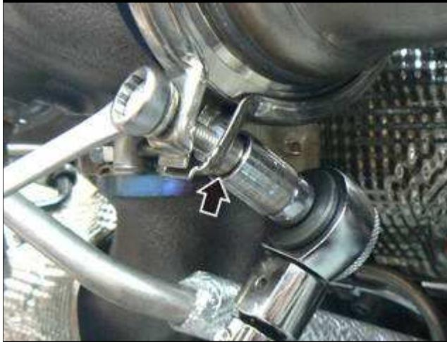
● 使用合适的扳手固定住螺钉以防其转动，同时拧紧指示的防松螺母。
